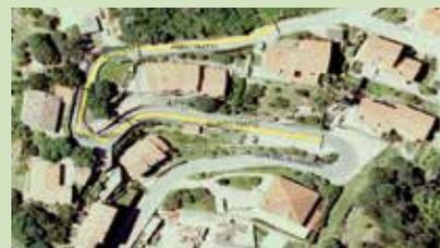
Si è trattato di un intervento di potenziamento dei sottoservizi, necessario per la suddivisione delle acque scure e chiare, con l'installazione di nuovi tratti di tubatura.
